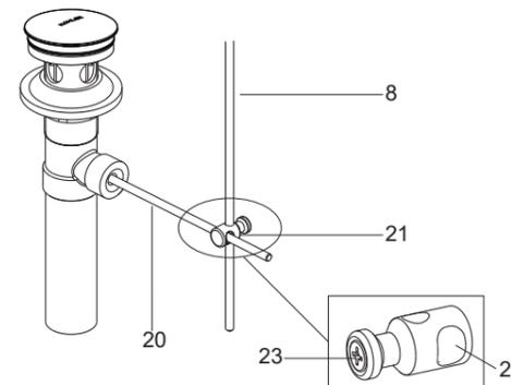
接头(21)大孔(22)套到球杆(20)上, 将提拉杆(8)插入接头小孔中。将球杆下推到排水器全开位置。锁紧接头上的螺钉(23)。
